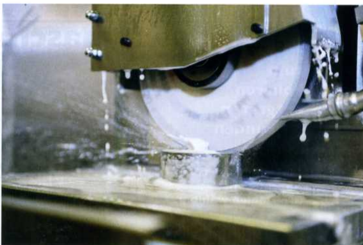
Bild 3: Das BIX Turbo System erzeugt mehr Volumen im Strahl des KSS, indem Mikrobällchen entstehen, die dann besser kühlen und die Schleifscheibe besser frei halten von Partikeln
