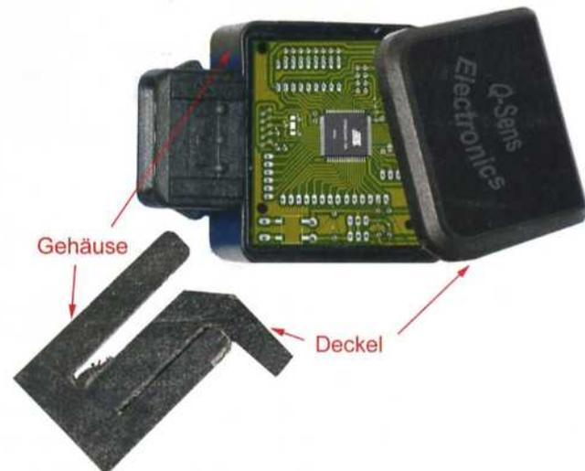
Die sehr geringe Belastung der zu verschweisenden Teile beim Torsionalschweißen schont empfindliche Elektronikbauteile.
