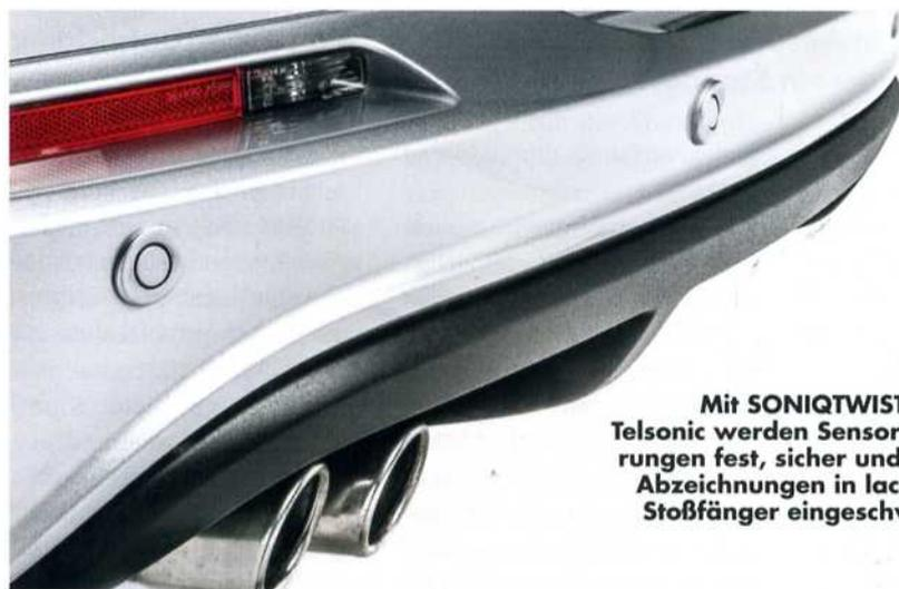
Mit SONIQTWIST® von Telsonic werden Sensorhalterungen fest, sicher und ohne Abzeichnungen in lackierte Stoßfänger eingeschweißt.
