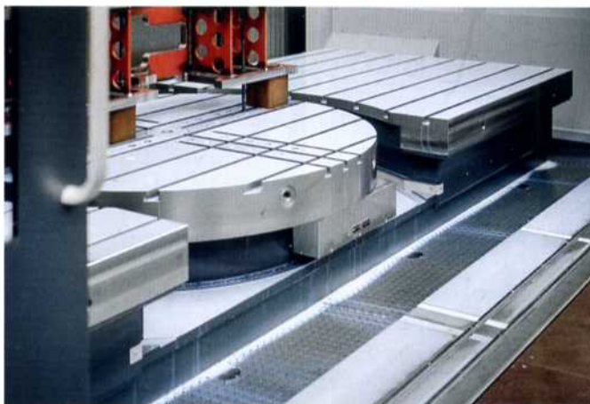
Der TightBlock nimmt den Rundtisch sowie eine Palettenspannstation mit Anbindung an einen optionalen 2-fach-Palettenswitcher auf.
