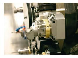
Schnittstellen HSK T in den Größen 40, 63 und 100 sowie PSC in 40. 50 und 63 erhältlich. Anwender realisieren damit Flexibilität bei der Werkzeugbestückung ihrer Drehzentren.
