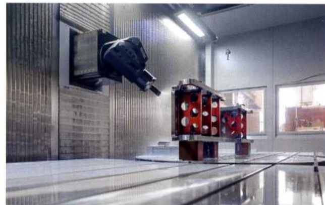
5 Anwender schätzen die Vollumhausung gerade bei den großen Abmessungen, haben sie doch dadurch ein abgeschlossenes Bearbeitungszentrum für die Großteilebearbeitung (© Jürgen Fürst)
