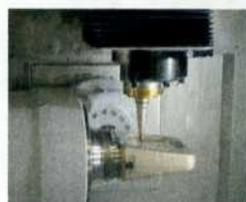
Die 2005 gegründete Etkon GmbH fertigt CAD/CAM-gestützt eine breite Palette von einfachen Einzelzahn-Versorgungen
