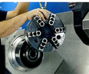
**Drehtechnik** | Einen rasanten Drehfutterwechsel unter 3 min ermöglicht das Futterschnellwechselsystem Rota FSW von Schunk. Statt über Befestigungsschrauben und einen Zugrohradapter
