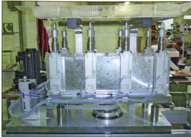
Per Ultraschall-Schweißtechnik von Telsonic werden Pad und Schale schnell und präzise verbunden Fotos: Telsonic
