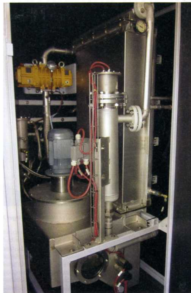
Der Verdampfer arbeitet mit einer Prozesswasserleistung von 100 l/h. Für die Verarbeitung von 1.000 Litern verbraucht der energieeffiziente ET 100 von MKR Metzger maximale 60 kW/h
