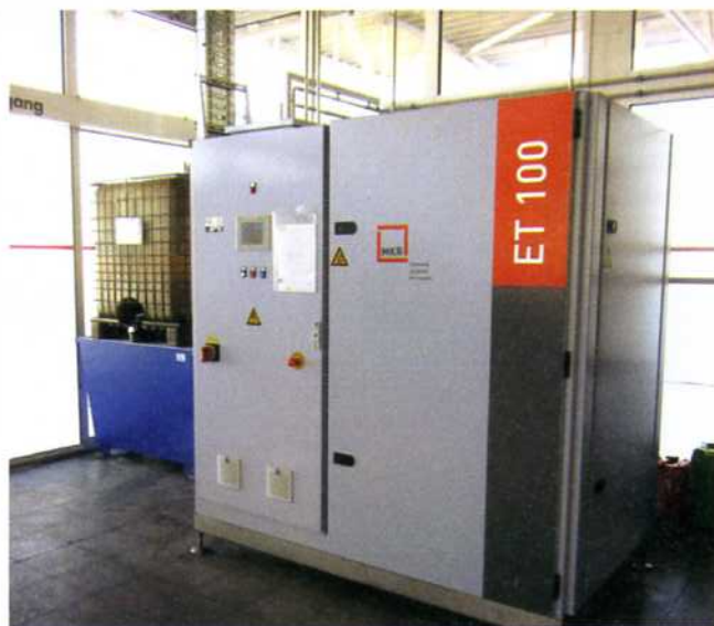
Nach Inbetriebnahme eines Verdampfers ET 100 von MKR Metzger hat ein Metallverarbeiter seine Entsorgungskosten um rund 90 % gesenkt
