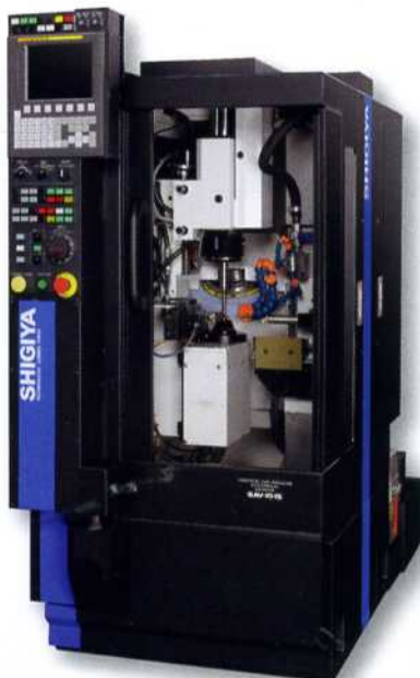
Die neue Vertikalmaschinen Shigiyu GAV kann Werkstücke bis 200 mm Länge bearbeiten und zum Schleifen von Polygonen eingesetzt werden.
