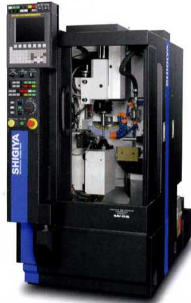
Die neue Vertikalmaschine „Shigiya GAV“ kann Werkstücke bis 200 mm Länge bearbeiten und zum Schleifen von Polygonen eingesetzt werden.
