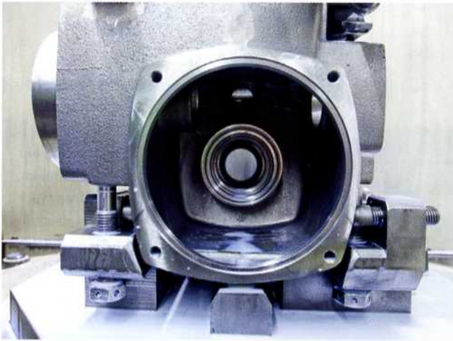
2 Das Gehäuse eines Stellantriebs durchläuft die Bearbeitungsschritte Bohren, Fräsen, Drehen, Gewindefräsen und Gewindeformen (© Oemeta)
