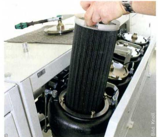
Die Filterpatronen der Feinstfilter Mikropur werden regelmäßig prozessparallel rückgespült. Bei Verschleiß lassen sie sich einfach, sauber und in kürzester Zeit austauschen.
