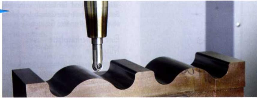
Interner Frästest bei LMT Kieninger, den jedes neue Werkzeug für den Gesenk- und Formenbau durchlaufen muss. Der CopyMax2 hat hierbei die Erwartungen übertroffen.
