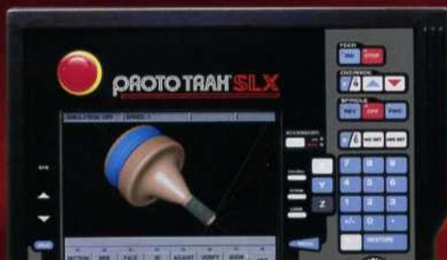
Steuerungseinheit für Drehmaschinen (ProtoTRAK® SLX)
