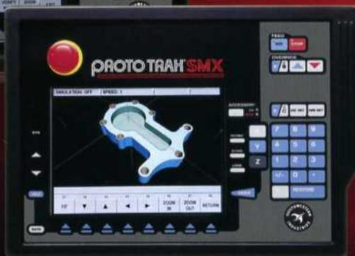
Steuerungseinheit für Fräsmaschinen (ProtoTRAK® SMX)
