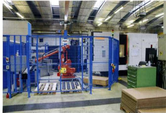
Seit 2014 produziert eine Fertigungszelle beim Unternehmen Biral vollautomatisiert hochwertige Pumpengehäuse.
