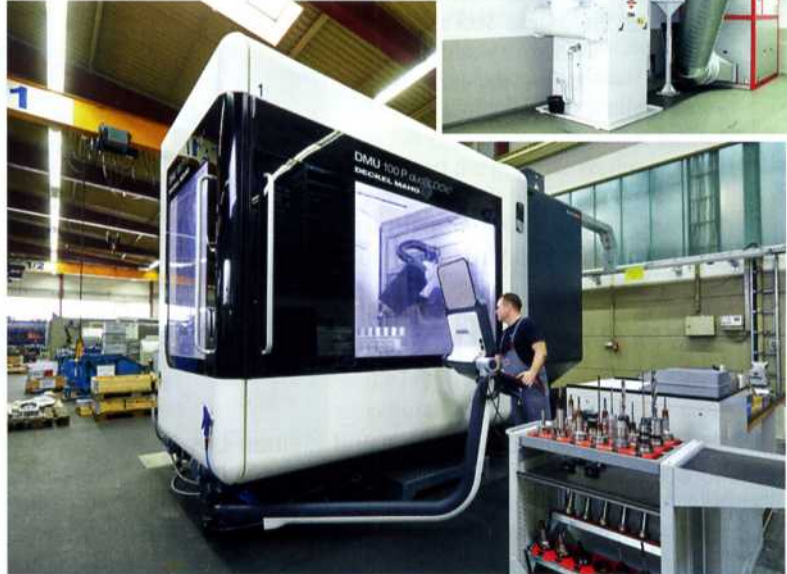
Für insgesamt elf Bearbeitungsmaschinen galt es eine effiziente und energetisch optimale Absauglösung zu finden. Das gewählte Konzept kombiniert einen Emulsionsnebelabscheider mit einem thermischen Energie-Rückgewinnungs-Modul.
