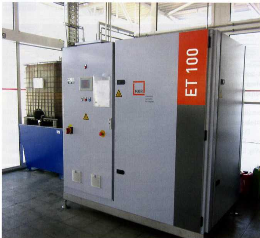
1 Der Verdampfer ET 100 zeigt sich für die Senkung der Entsorgungskosten um rund 90 Prozent verantwortlich (Bild: MKR Metzger)
