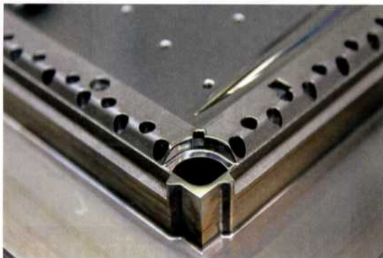
Bild 5. Das Lasertexturieren ist besonders konturgenau – wie hier bei einem Werkzeug für die Medizintechnikbranche.
