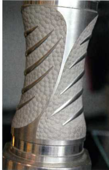
Bild 3. Mit der Lasertechnik können die Texturen auch direkt in ein Prototypenteil eingebracht werden – das spart Werkzeugkosten für die Prototypen. Hier ist das Designmuster einer Getränkeflasche zu sehen.
