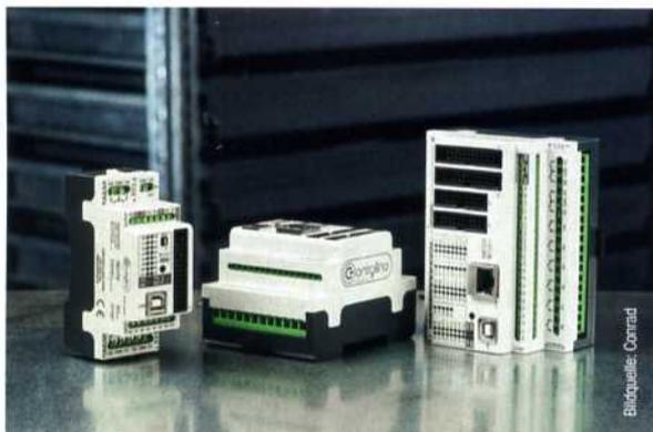
Ausgänge, zwölf Analog-/Digital-Eingänge und zwölf Digital-Ausgänge) sowie einen Ethernet-Port und eine zweite RS232-Schnittstelle. Noch mehr I/Os stehen beim Mega-Modul bereit: 16 Relais-Ausgänge für Ströme bis 30 A, 24 Analog-/Digital-Eingänge, zwölf High-Side-Switch-Digital-Ausgänge und zwölf weitere Halbbrücken-Digital-Ausgänge. Mit den Steuerungen ergänzt der Distributor sein bestehendes Angebot an über 1500 SPS-Varianten von Herstellern wie Siemens, C-Control, Wago und Phoenix Contact.
