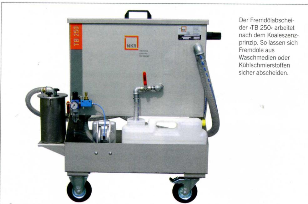
Der Fremdölabscheider »TB 250« arbeitet nach dem Koaleszenzprinzip. So lassen sich Fremdöle aus Waschmedien oder Kühlschmierstoffen sicher abscheiden.
