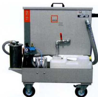
Bild: Mobil oder stationär einsetzbare Fremdölabscheider (Werkbild: MKR Metzger GmbH, Monheim)
