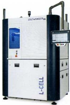
**Die neue, flexible, roboter-basierte Laseranlage L-Cell markiert, kennzeichnet und beschriftet Freiformflächen von Produkten mit komplexen Geometrien** Foto: Zeltwanger
