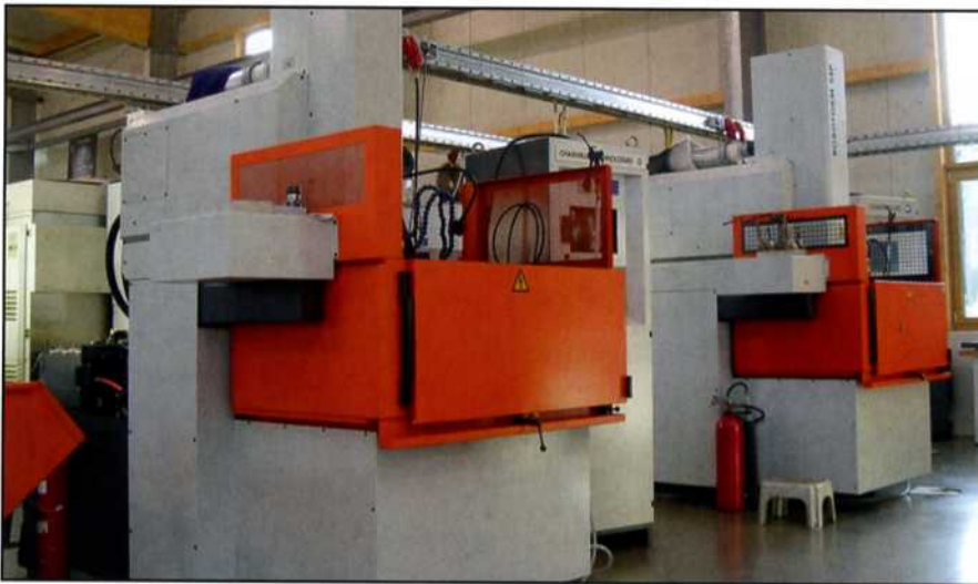
Die AgieCharmilles Drahterodiermaschinen von GF Machining Solutions arbeiten bei Hartex autark, benötigen aber reinstes Prozesswasser mit dauerhaft niedrigem Leitwert, das Geräte der Easymetal Prozesstechnik GmbH zur Verfügung stellen.
