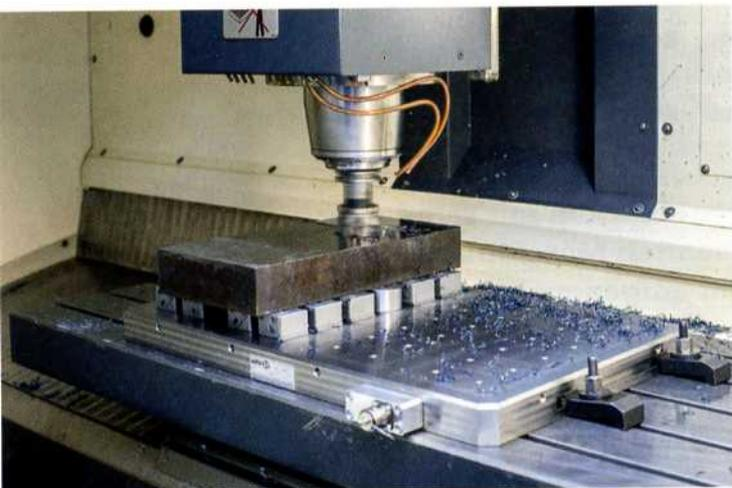
Die Vollmetall-Ausführung der neuen »Premium-Line«-Magnetspannplatten widersteht heißen Spänen und aggressiven Kühlschmiermitteln.
