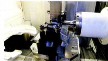
deren Schnittstelle einen schnellen Wechsel ermöglicht. Auf ihr befinden sich die ebenfalls mit einer zentralen Schraube schnell wechselbaren Werkstückaufnahmen, der Luftanlagekontrollanschluss, die Späneablaufschrägen sowie die Schnittstellen für drei hydraulisch betätigte Schwenkspanner je Seite. Die spannen die Pumpengehäuse so, dass für Werkzeuge und Greifer der benötigte Freiraum bleibt. Obwohl nur drei Hydraulikzylinder arbeiten, ist auch ein Wechsel auf vier Backen möglich.
