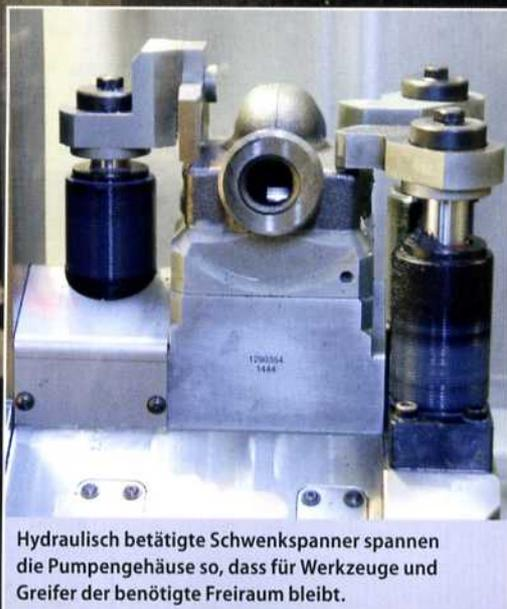
Hydraulisch betätigte Schwenkspanner spannen die Pumpengehäuse so, dass für Werkzeuge und Greifer der benötigte Freiraum bleibt.
