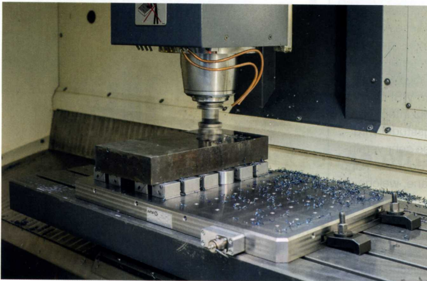
Bild 1: Die Vollmetall-Ausführung der neuen Premium Line Magnetspannplatten widersteht heißen Spänen und aggressiven Kühlschmiermitteln
