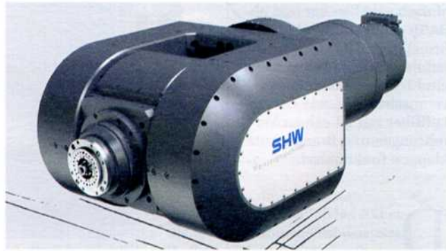
Der neue Gabelfräskopf von SHW Werkzeugmaschinen eignet sich besonders für die 5-Achs-Simultanbearbeitung im klassischen Maschinenbau sowie für das Schlichten im Formenbau
