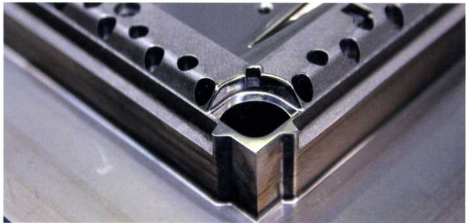
Lasertexturieren ist höchst konturgenau, z.B. bei einem Werkzeug für die Medizinbranche (Bild: Reichle)
