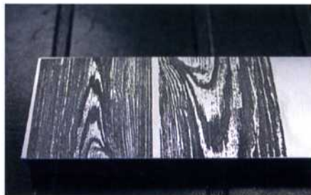
Schichtdicken mit weniger als 2 µm sind möglich, genauso wie das Abbilden organischer Strukturen, wie eine Holzmaserung (Bild: Reichle)
