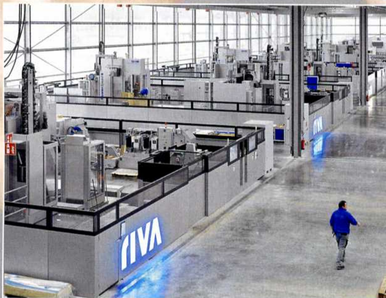
Zehn Fahrständermaschinen von SHW Werkzeugmaschinen bearbeiten bei Riva in Backnang Werkstücke aus Edelstahl und Aluminium für Mekka.
