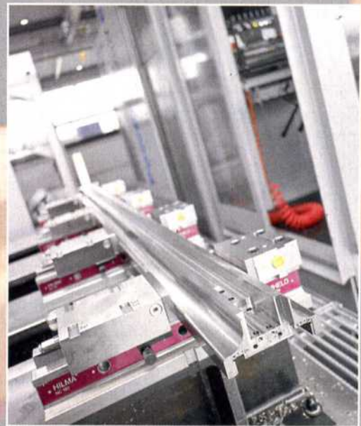
Nach der Schwerzerspannung wiegt ein Profil etwa 300 kg weniger.
