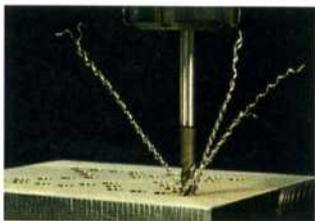
**Zerspanung** – js. Die Eigenschaften von rostfreiem Stahl sorgen dafür, dass das Material auch mit Spezialwerkzeugen nur schwer zerspanbar ist. Dem will die Wexo Präzisionswerkzeuge GmbH mit der Werkzeugserie XTOP abhelfen. Beim Schafffräser wurden Schneidengeomet-
