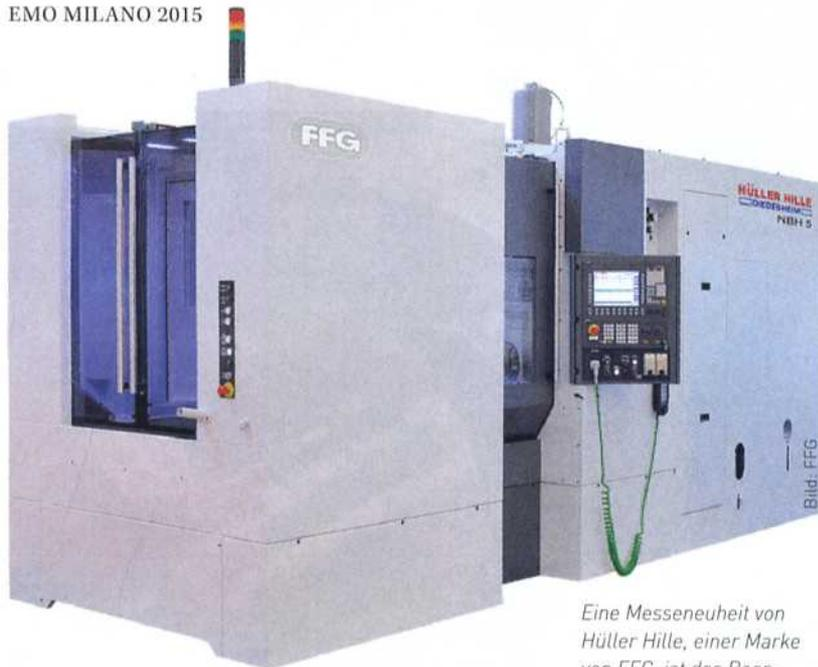
*Eine Messeneuheit von Hüller Hille, einer Marke von FFG, ist das Bearbeitungszentrum NBH 5 aus der renommierten NBH-Baureihe. Als kompakte, hochdynamische Maschine zur Direktbeladung eignet es sich für den Einsatz in Fertigungszellen.*
