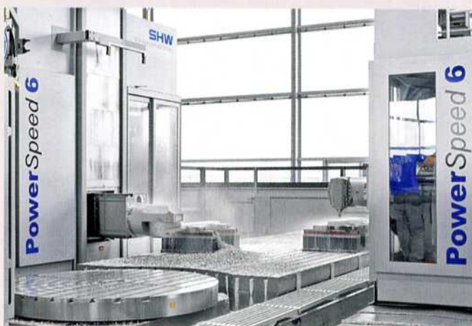
Durch die Parallelbearbeitung von großen, schwer zu handhabenden Werkstücken spart RIVA viel Bearbeitungszeit und erhöht die Produktivität und Qualität bei nur einer Aufspannung.
