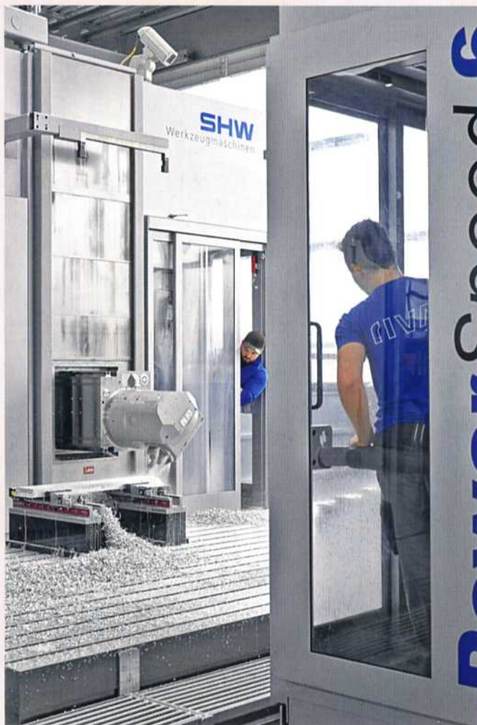
Mit einer Fahrgeschwindigkeit von 30.000 mm/min. kommen die Doppelständer der PowerSpeed 6 auf ihrem 14.000 mm langen Verfahrensweg schnell an jede Stelle der bis zu 12.000 mm langen Werkstücke.
