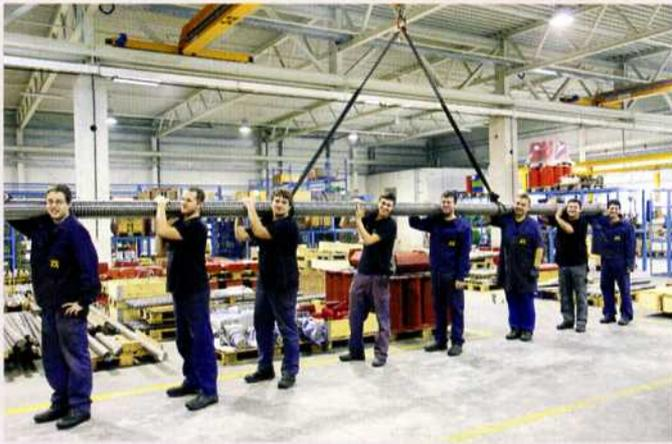
Die mit knapp 12 m Länge und 160 mm Durchmesser größte von der Maschinenfabrik Albert hergestellte Spindel.
