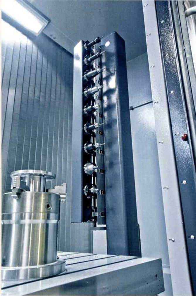
**Die UniSpeed 7 verfügt über einen automatischen Werkzeugwechsler sowie eine Pick-up-Station für Werkzeuge.**
