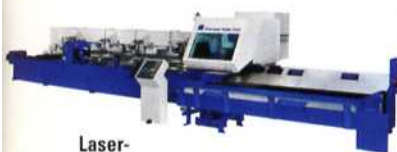
Laser-Rohrschneidanlage, die in einer Aufspannung Rohre ablängen sowie Aussparungen und Konturen einbringen kann
