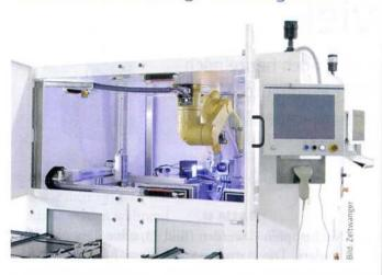
Die Kennzeichnung medizintechnischer Produkte ist ein wichtiger Qualitätsaspekt und schafft Sicherheit bei Rückverfolgung und Haftungsfragen. Eine flexible, roboterbasierte Anlage von Zeltwanger kennzeichnet hierfür Keramikkugeln und -kalotten von Hüftgelenksimplantaten aus Keramik mit dem Laser.
