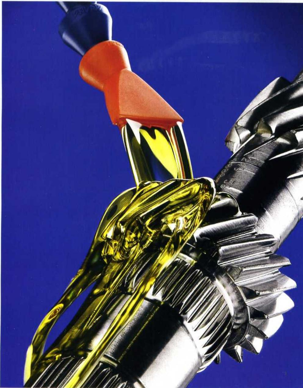
**M**indestens genauso wichtig ist für Malte Krone, Leiter Produktmanagement bei Oemeta, dass die Bearbeitungsöle aus nachwachsenden Rohstoffen formuliert und dadurch gut biologisch abbaubar sind. Außerdem bleiben die esterbasierten Produkte nach Inkrafttreten der neuen CLP-Verordnung weiterhin kennzeichnungsfrei; auch für Oemetol 546 und 556, obwohl diese mit Viskositäten von 4,2 oder 10,2 mm<sup>2</sup>/s deutlich unter der neuen Grenze
