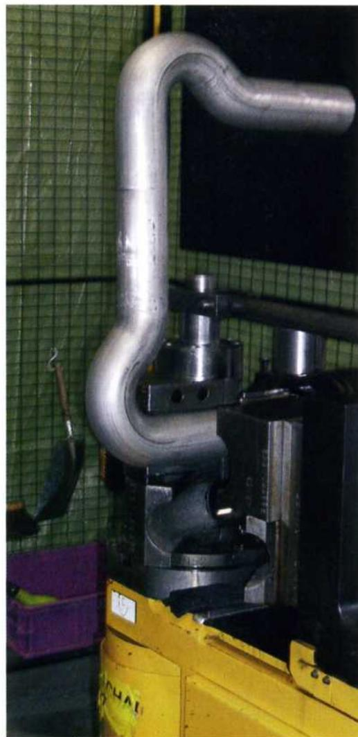
Rund 160.000 der Abgasendrohre für Nobel-Geländewagen wie den Audi Q7 werden bei Ulmo jährlich auf den Silfax-Maschinen gefertigt. In einem Biegeprozess werden dazu immer zwei Abgasendrohre gebogen.
