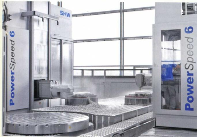
12.000 x 2.500 mm. Hierzu sind die Maschinen mit dem automatischen Universalfräskopf in orthogonaler Bauweise und dem Gabelkopf mit Hochfrequenzspindel ausgestattet.
