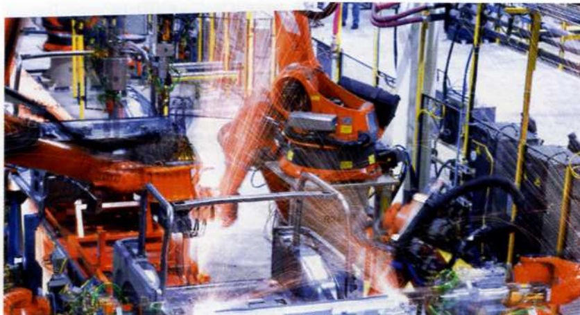
In der Automobil- und Zulieferindustrie übernehmen Roboter vielfältigste Aufgaben – von der Body-in-white-Karosserieherstellung über die Lackierung bis hin
