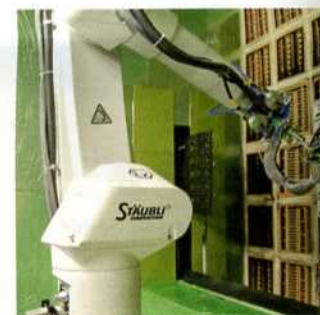
Der Roboter arbeitet mit unterer Strahlbündelung sowie A-tung in den Umkehrpunkten
