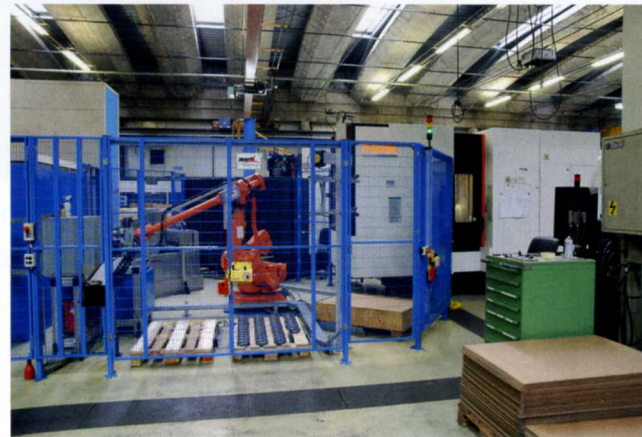
Bild 2: Seit 2014 produziert eine Fertigungszelle bei Biral vollautomatisiert Pumpengehäuse in Losgrößen zwischen 150 und 8.400 Stück
