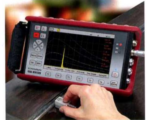
mit den Bewertungsverfahren DAC, AVG, AWS und JIS. Ebenfalls neu ist ein bis zu einer Amplitude von 320 V stufenlos einstellbarer Rechtecksender, dessen Pulsbreite beim Laden der Prüfkopfparameter automatisch der Prüfkopffrequenz angepasst wird.
