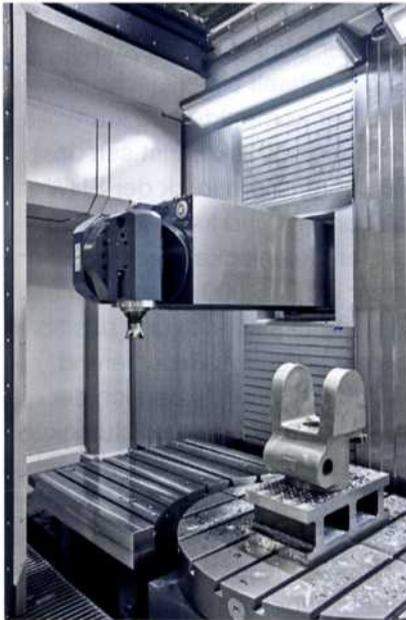
Bild 2: Der Arbeitsbereich der neuen UniSpeed 7 umfasst in der X-Achse bis 6000 mm, in der Y-Achse bis 1.600 mm und in der Z-Achse bis 1.300 mm
