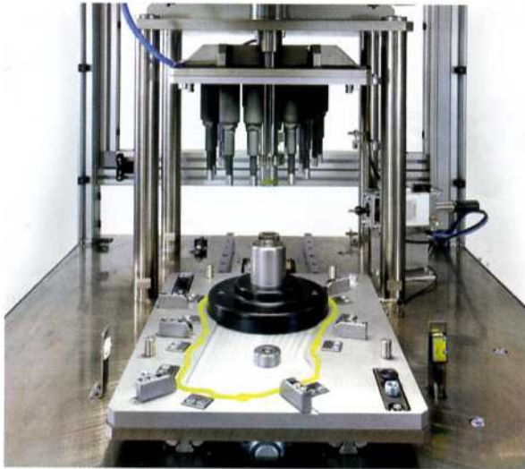
Bild 2. Mit kurzen Taktzeiten lässt sich eine modular aufgebaute Dichtheitsprüfanlage mit Schiebeschlitzen in eine 100-Prozent-Kontrolle einbinden.
