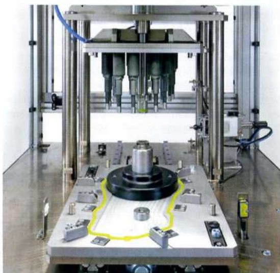
Der Schiebeschleitten der Dichtheitsprüfanlage lässt sich sowohl manuell als auch automatisiert durch Roboter beladen
