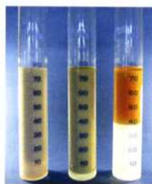
Fremdölabscheidungsvermögen von Hycut im Vergleich zu mineralölbasierten Standardprodukten (nach 24 h).
