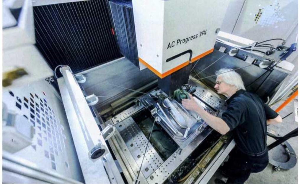
nik werden Implantate, kleinste Instrumente und hauchdünne chirurgischen Klingen für Augenoperationen gefertigt. Anschließend erfolgt eine Hundertprozentkontrolle unter dem Mikroskop. Beides fertigen die Erodier-Experten auf mehreren „Cut 1000“ von GF Machining Solutions. Neben der hochpräzisen Fertigung liegt in beiden Fällen eine große Herausforderung im Spannen der Werkstücke und in deren Handhabung. „Hier zeigt sich
