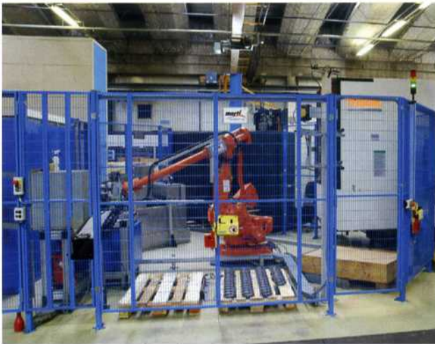
2 Seit 2014 produziert eine Fertigungszelle bei Biral vollautomatisiert Pumpengehäuse in Losgrößen zwischen 150 und 8400 Stück
