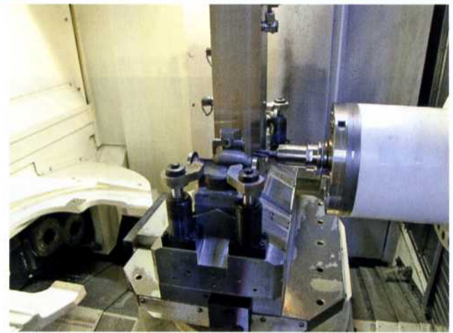
5 Auf dem Mazak-BAZ werden die Pumpengehäuse abglenzt, plangefräst und an der Außenseite mit einem Zollgewinde versehen (Bild: Röhm)
