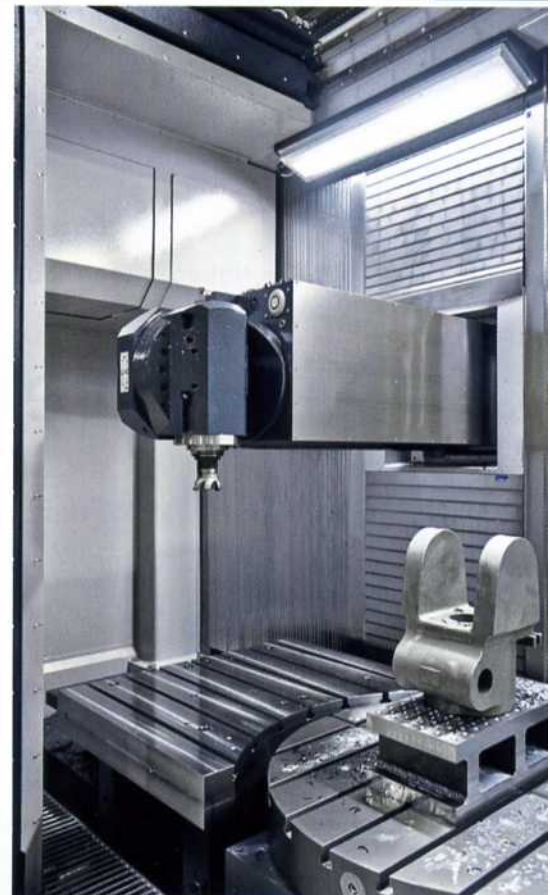
3 Der Arbeitsbereich der UniSpeed 7 umfasst in der X-Achse bis 6000 mm, in der Y-Achse bis 1600 mm und in der Z-Achse bis 1300 mm (Bild: SHW)
