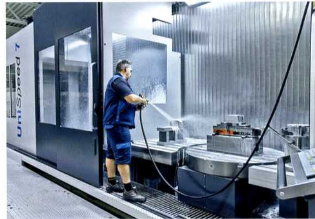
2 Die neue UniSpeed 7 erleichtert dem Bediener mit nur einer Stufe bis zur Aufspannfläche die Zugänglichkeit und ist Teil des verbesserten Ergonomiekonzepts (Bild: SHW)
