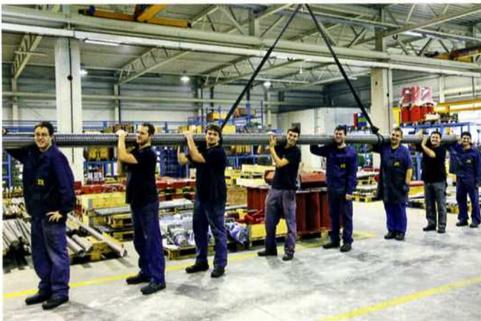
1 Mit knapp 12 m Länge und 160 mm Durchmesser ist diese Spindel die größte, die je von der Maschinenfabrik Albert hergestellt wurde
